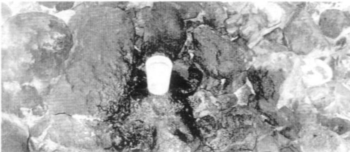
FOTO n° - 5 - Gocciolamento dell'acqua all'interno del bicchiere di plastica, posizionato per la raccolta del liquido da sottoporre ad analisi di caratterizzazione.
